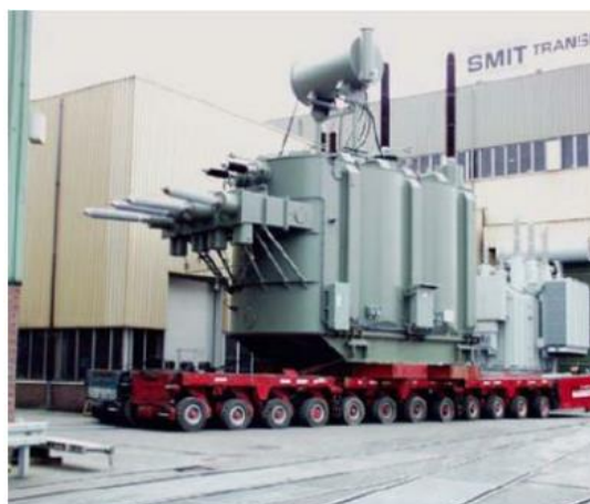
obr. 5-2 Jednofázová jednotka PST od firmy Smit [26]
